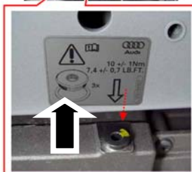
② プラグ締め付けトルクラベル
