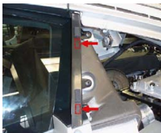
⑦ Bピラートリム、サイド ブレード間のフォーム
