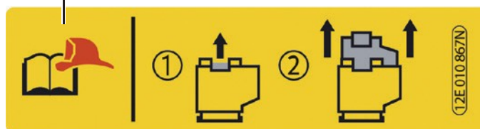
緊急遮断ポイント部のラベル (高電圧システム遮断操作の説明用)
