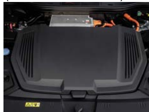
モータールーム (オレンジ色のケーブル)
