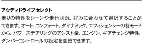
走りの特性をシーンや走行状況、好みに合わせて選択することができます。オート、コンフォート、ダイナミック、エフィシエンシーの各モードから、パワーステアリングのアシスト量、エンジン、ギアチェンジ特性、ダンパーコントロールの設定を変更できます。
